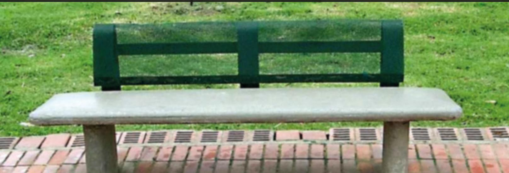
Banca fabricada en concreto reforzado 3.000 psi, con acabado liso de presentación a la vista color gris basalto, con refuerzo interno en la loza de malla electro soldada y refuerzos longitudinales en barrilla redonda corrugada, según norma IDU.
